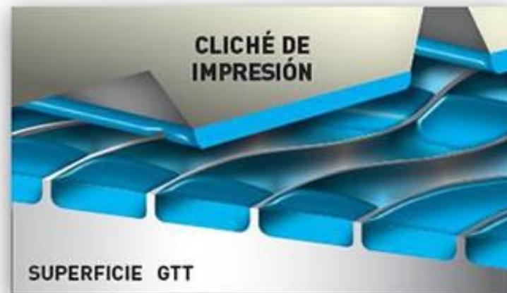
La estructura abierta GTT realiza una transferencia sin tensiones y consistente. La menor aireación, los canales menos profundos y zonas de contacto más estrechas permiten transferir el volumen de tinta ideal a la plancha.
