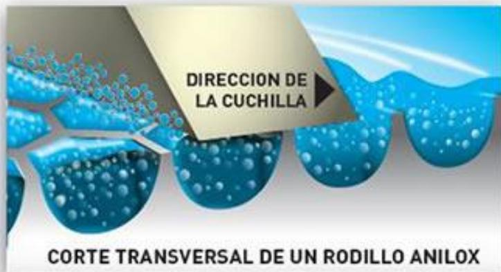
La geometría de celda convencional crea aireación y turbulencias en la tinta al paso de la cuchilla. Puede causar espumación y salpicado.
