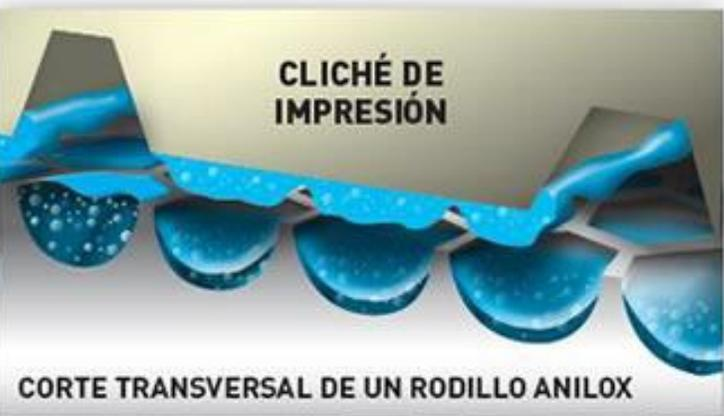
En los rodillos tradicionales la tensión de la tinta y la reserva de las celdas provocan una transferencia irregular, fuerzan a la tinta entre los puntos y no vacían completamente las celdas.
